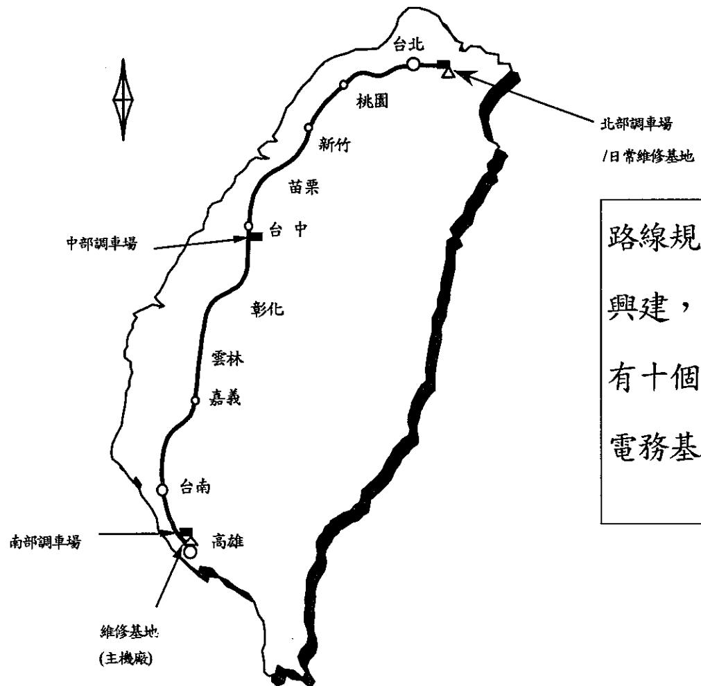
路線規劃全長約 340 公里，約有 75% 路段採高架方式興建，為一專用路軌。沿線共經過十四個縣市，設置有十個車站、北中南三處基地、新竹及嘉義兩處工、電務基地及橋頭維修機廠。
